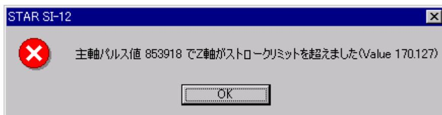
エラーメッセージには、ストロークリミットオーバーが発生した軸、データ位置（この場合、主軸パルス値 853918 のとき）及びそのときの軸の値が表示され、この内容は LOG ファイルに記録されます。
