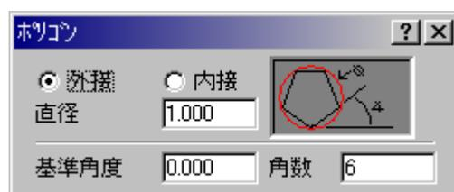
外接値を入力したい場合は「外接」を、内接値を入力したい場合は「内接」を選択します。直径値は、ポリゴンの内側または外側円の直径です。基準角度は、底辺の線分角度です。角度は、X軸の位置から反時計回りに測定されます。
