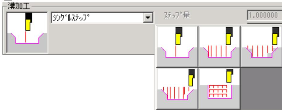
溝加工のタイプとして、[シングルステップ] [可変マルチステップ (水平面上)] [一定マルチステップ] [可変マルチステップ] [水平ベックスステップ] のいずれかに設定します。
