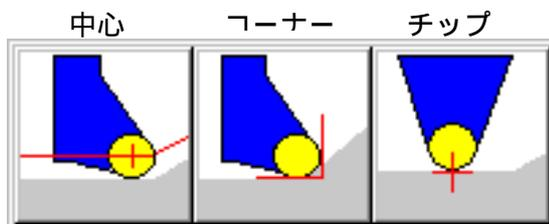
「チップ」タブの「チップタイプ」を [溝切り]にした場合、左刃先/左中心/右側刃先/右側中心、から選択します。以下に、これらのそれぞれを示します。
