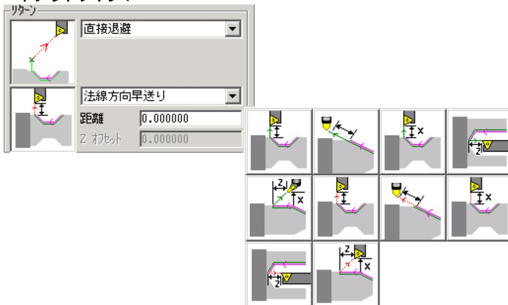
「リードアウトタイプ」は、[ 法線方向切削 ] / [ 接線方向切削 ] / [ X方向切削 ] / [ Z方向切削 ] / [ X,Z位置切削 ] / [ 法線方向早送り ] / [ 接線方向早送り ] / [ X方向早送り ] / [ Z方向早送り ] / [ X,Z位置早送り ] のいずれかに設定します。「リードアウトタイプ」はオペレーションの終わりの移動に関連します。
